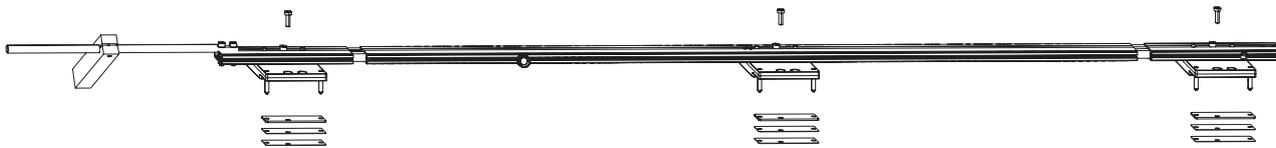
Teleskopstangen-Set (überschlagverschraubt) bestehend aus: 1 Teleskopstange, 3 Zylinderschrauben, 12 Distanzplatten 2 mm, 6 Distanzplatten 1 mm, 3 Distanzplatten 0,5 mm, 1 Montageanleitung
