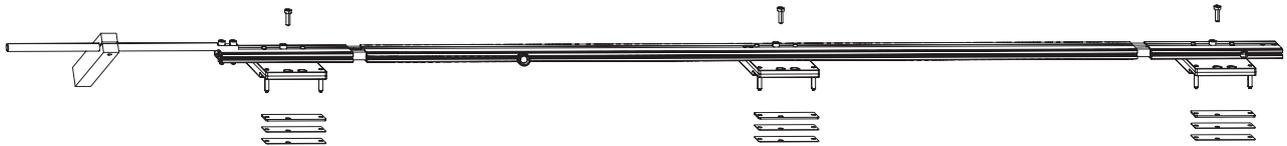
Teleskopstangen-Set (überschlagverschraubt) bestehend aus: 1 Teleskopstange, 3 Zylinderschrauben, 12 Distanzplatten 2 mm, 6 Distanzplatten 1 mm, 3 Distanzplatten 0,5 mm, 1 Montageanleitung
