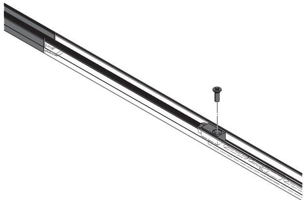
4. Kappen entsprechend der gewünschten Verschlusspunkte brechen und unter jedem Schraubloch 1 Unterlage einklippen → **ab Seite 85**.
