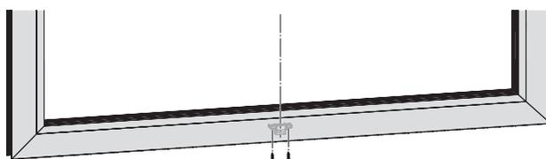
Stützbock mittig - zum Flügel und in der Nut - ausrichten und mit 2 mitgelieferten Schrauben festschrauben.
