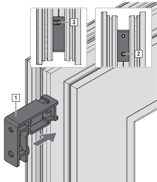
2. Dübel seitlich in Ø 7 Loch einsetzen und festschrauben.
