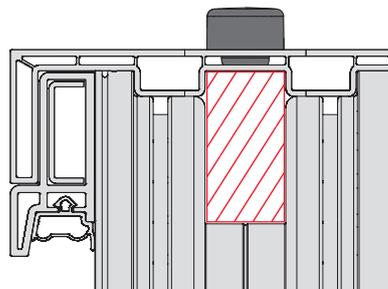
2. 2 Bohrungen  $\varnothing 10$  mm für Gummipuffer durch die Abdeckung oben und unten vornehmen.
