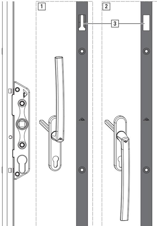
1. Getriebe in Schließstellung in Ecklaufwagen einhängen.
