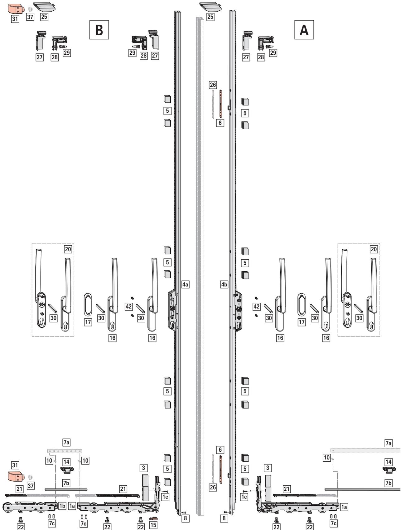
Abb. 4.10: abgebildet: FG 300 kg; [A] Erstöffnender Flügel: Ausschnitt Ausführung rechts; FB 1400 mm; FH 2400 mm; [B] Zweitöffnender Flügel: Ausführung links; FB 1400 mm; FH 2400 mm; grau gestrichelt: Stulpprofil profilspezifisch
