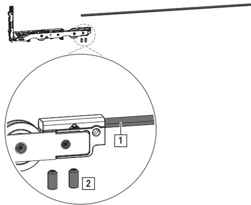
2. **FB ≥ 1800 mm: Stützbock montieren**, für Profile mit offener Nut die keine Fräsung benötigen.
