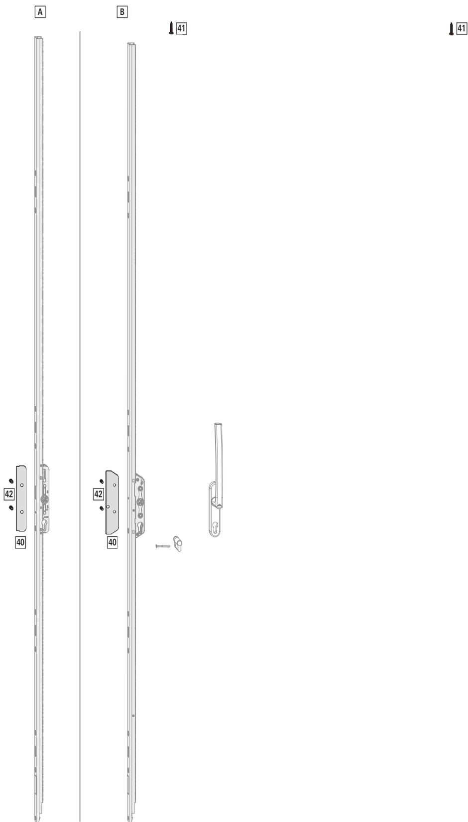
Abb. 4.11: abgebildet: Schema A; Ausführung links; FH 2400 mm; Slim [A] 200 kg und Standard [B] FG 300 / 400 kg; abschließbare Griffe
