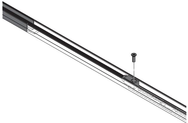
4. Kappen entsprechend der gewünschten Verschlusspunkte brechen und unter jedem Schraubloch 1 Unterlage einklippsen → *ab Seite 91*.
