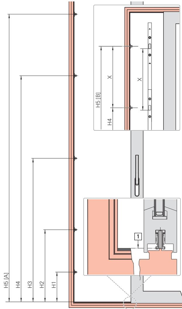
2. Schließbolzen mit 2 Schrauben festschrauben.
