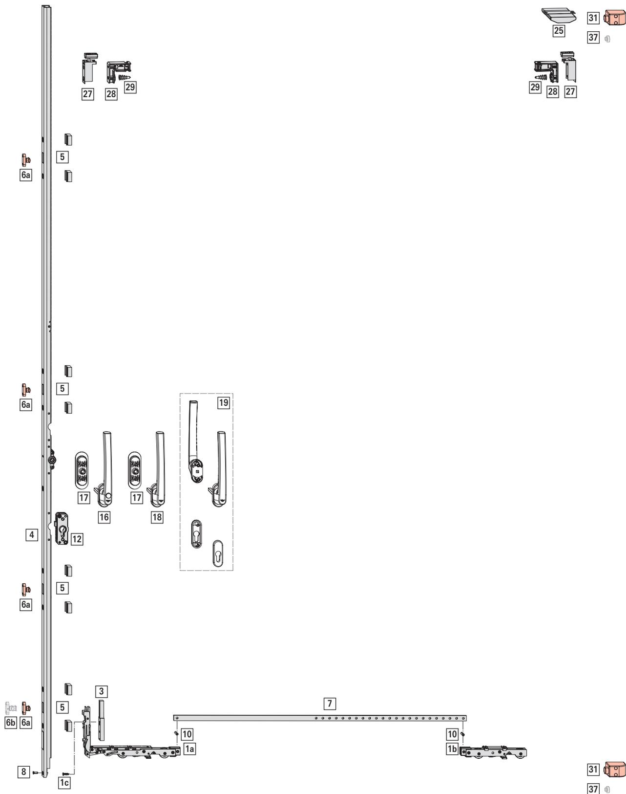
Abb. 4.1: abgebildet: Ausführung links; FB 1400 mm; FH 2400 mm; FG 150 kg
