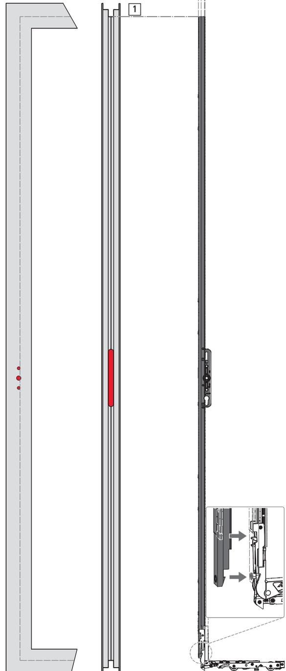
1. Kappen [2] entsprechend der gewünschten Verschlusspunkte aus Getriebe ,wenn nötig auch aus Getriebeverlängerung, brechen.
