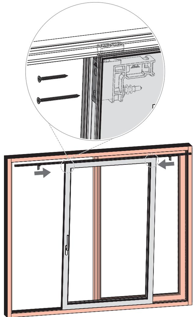
4. Führungsschiene am Rahmenprofil nach Vorgaben des Profilverstellers festschrauben.
