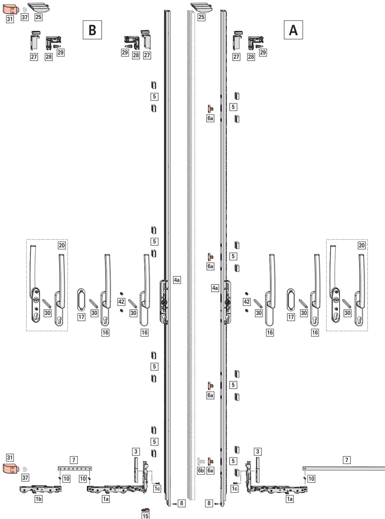
Abb. 4.7: abgebildet: FG 200 kg; [A] Erstöffnender Flügel: Ausschnitt Ausführung rechts; FB 1400 mm; FH 2400 mm; [B] Zweitöffnender Flügel: Ausführung links; FB 1400 mm; FH 2400 mm; grau gestrichelt: Stulpprofil profilabhängig
