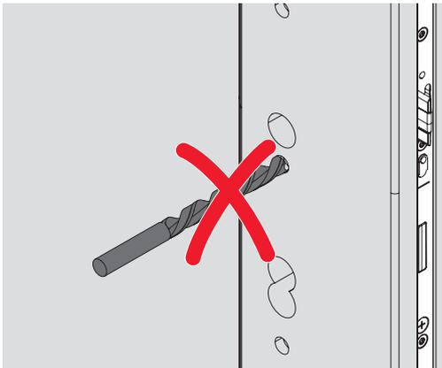
Türblatt im Schlossbereich nicht bei eingebauter Verriegelung (z. B. für Schutzbeschläge) durchbohren.
