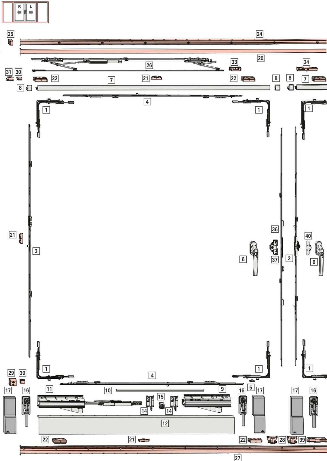
abgebildet: bis 160 kg; RC 1 N; FFB 1000; FFH 1300; DK-Getriebe mittig/variabel; DK-Getriebe mittig/variabel zweit-öffnender Flügel mit aufgeschweißtem Schließstück; mit Kipplüftung zwangsgesteuert
