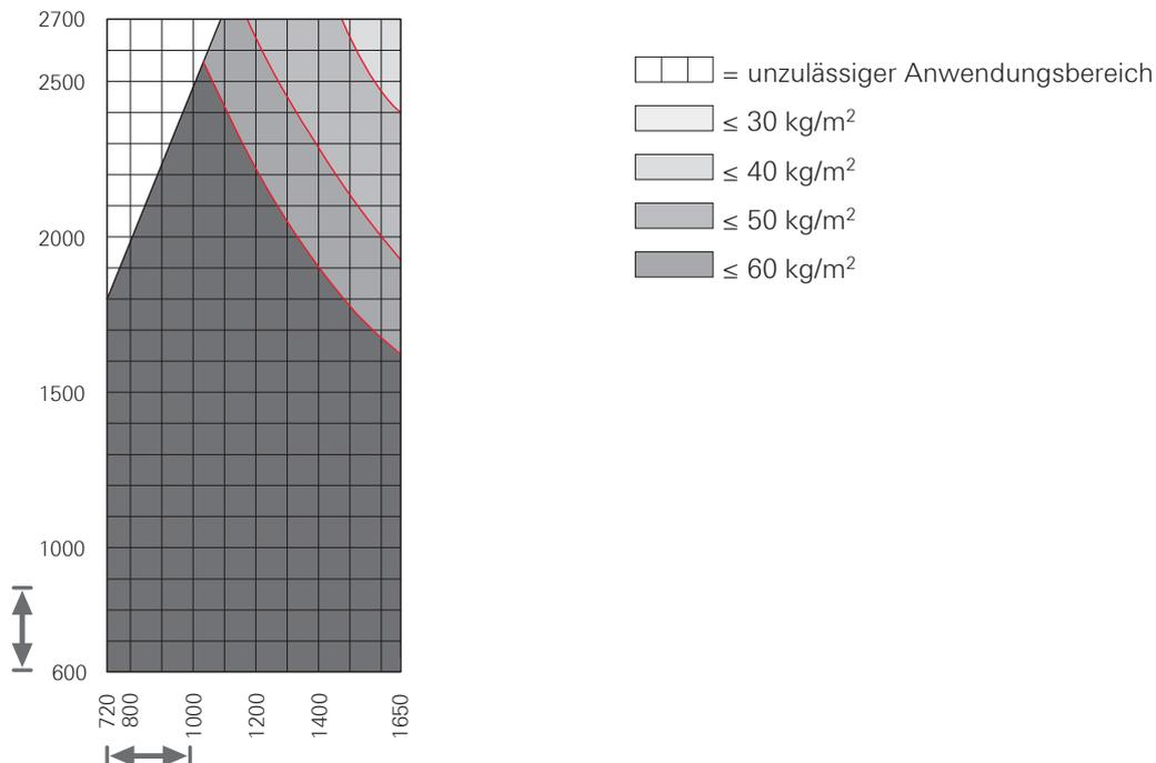
Die Angaben im Anwendungsdiagramm bezeichnen das Glasgewicht in  $\text{kg/m}^2$ .
