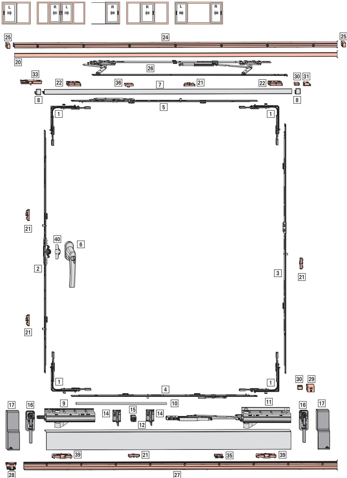
abgebildet: bis 160 kg; RC 1 N; FFB 1000; FFH 1300; DK-Getriebe mittig/variabel; mit Kipplüftung zwangsgesteuert
