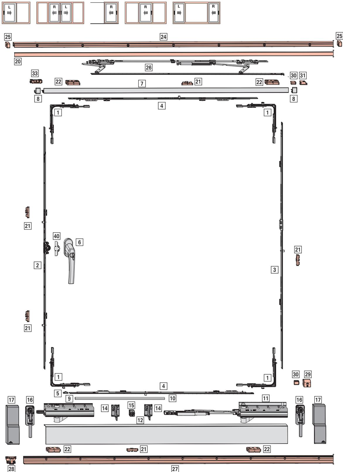
abgebildet: bis 160 kg; RC 1 N; FFB 1000; FFH 1300; DK-Getriebe mittig/variabel; ohne Spaltlüftung
