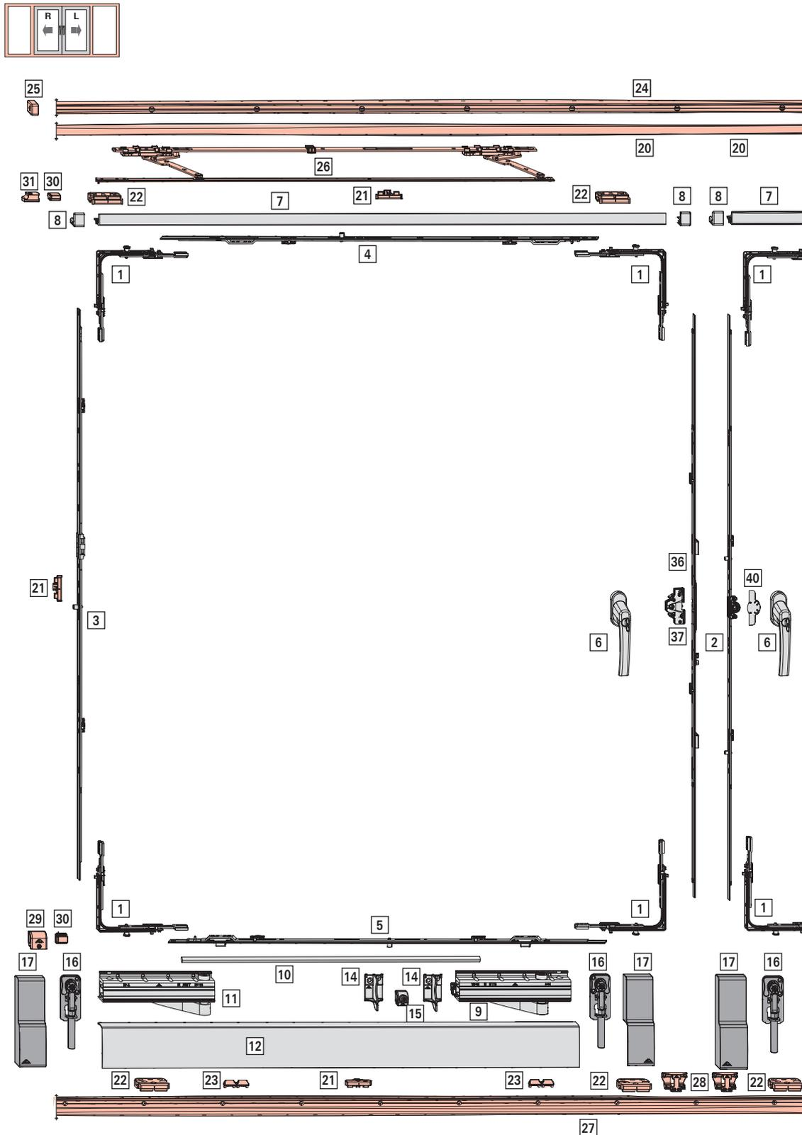
abgebildet: bis 160 kg; RC 1 N; FFB 1000; FFH 1300; DK-Getriebe mittig/variabel; DK-Getriebe mittig/variabel zweit-öffnender Flügel mit aufgeschweißtem Schließstück
