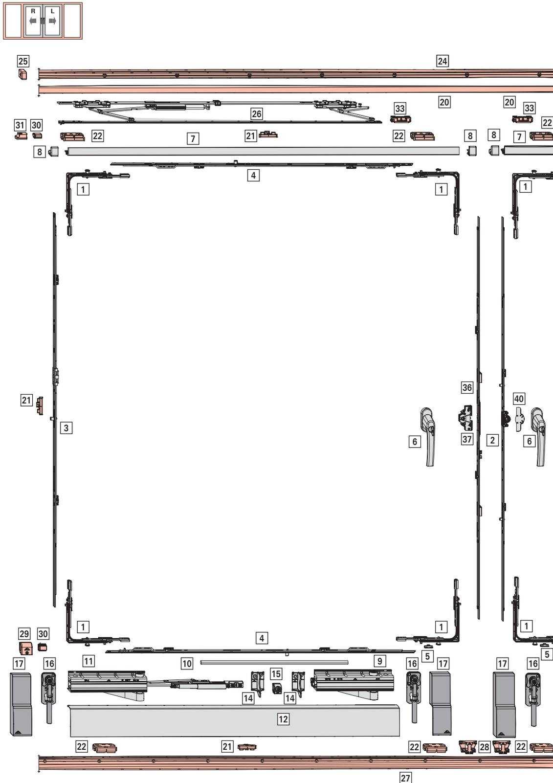
abgebildet: bis 160 kg; RC 1 N; FFB 1000; FFH 1300; DK-Getriebe mittig/variabel; DK-Getriebe mittig/variabel zweit-öffnender Flügel mit aufgeschweißtem Schließstück; ohne Spaltlüftung
