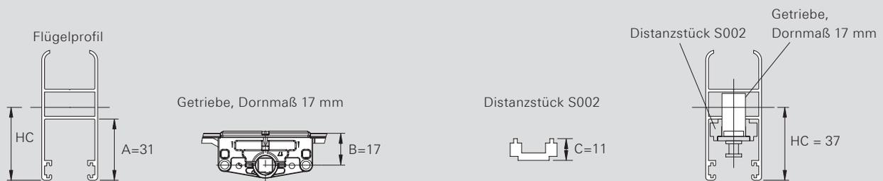
2. Distanzstück vor dem Zusammenbau der Profile einsetzen. Distanzstück am Getriebekasten teilen.
