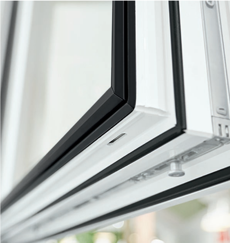
Ein werksseitig aufgebrachtes Klebeband fixiert das Dichtprofil SP 7447 K als Anschlag- und Verglasungsdichtung am Glas. Eine große Hohlkammer sorgt für hohen Toleranzausgleich. Bild: Gealan Fenster-Systeme GmbH
