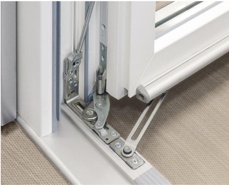
Roto Designo gewährleistet höchste Stabilität für Flügelgewichte bis 150 kg durch die robuste Lastabtragung – hier in Verbindung mit der Bodenschwelle Roto Eifel TB. Der Drehbegrenzer entlastet den im Ecklager integrierten Endanschlag und verhindert eine Beschädigung des Beschlags bei plötzlicher Belastung durch zum Beispiel einen Windstoß.
