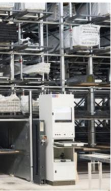
■ Aus dem neuen Hochregallager mit seinen 232 Kassettenplätzen werden die Arbeitsplätze in der Kunststofffensterfertigung über ein automatisches Shuttle-System versorgt.
