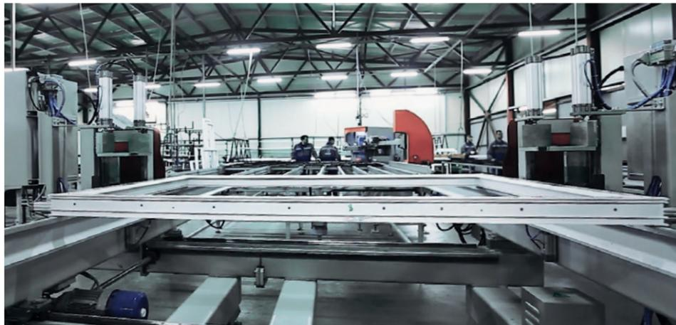
Der in Mogilev ansässige belarussische Marktführer von Bauelementen aus Kunststoff und Aluminium verfügt über eine Produktionskapazität von rund 1.500 Fenstereinheiten pro Tag. Das Produktionsvolumen kann flexibel verdoppelt werden.
