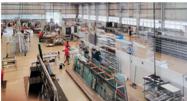
Pro Monat fertigt Wigga rund 1.500 Elemente. Etwa ein Drittel der produzierten Elemente sind Schiebeanlagen mit Roto Inline.
