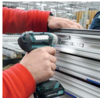
AR.MA. vyrábí plastová okna a balkonové dveře. Obrázek ukazuje montáž okapnice Komfort od Roto.
