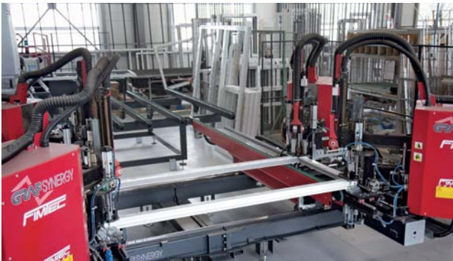
B.FT byla první společností v Polsku, která v roce 2014 přešla na automatické svařování okenních profilů.
